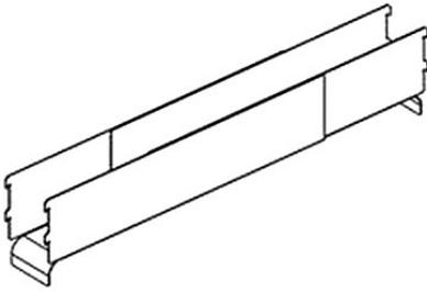
Kabel-Management-Rinne für den Einbau von vorn nach hinten, tiefenverstellbar
