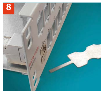
4 Modul nach unten in die Öffnung einkippen; dabei das Montage-Tool nach vorne ziehen Insert the jack completely while pulling the mounting tool at the same time.
